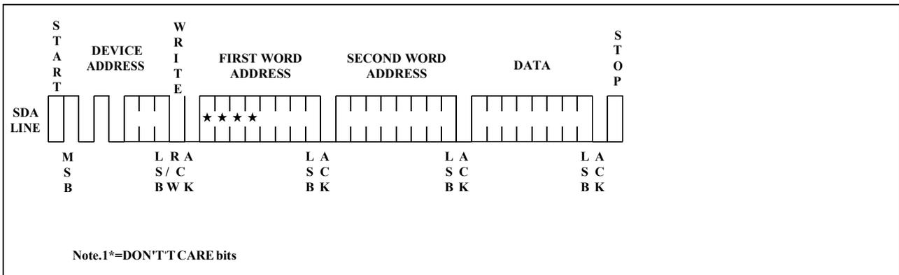
**Figure 6. Byte Write**
