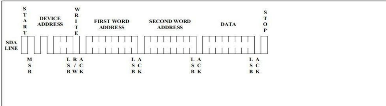
**Figure 6. Byte Write**
